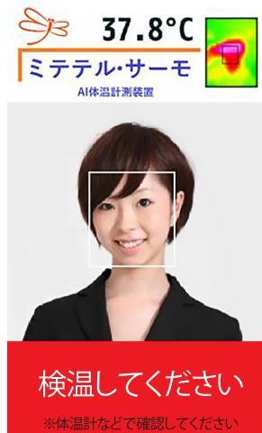
設置したデバイスから 0.3~0.5m 程度の場所で数秒停止すると、非接触で体表面温度を計測します。マスクを着けたままでも検温可能です。
